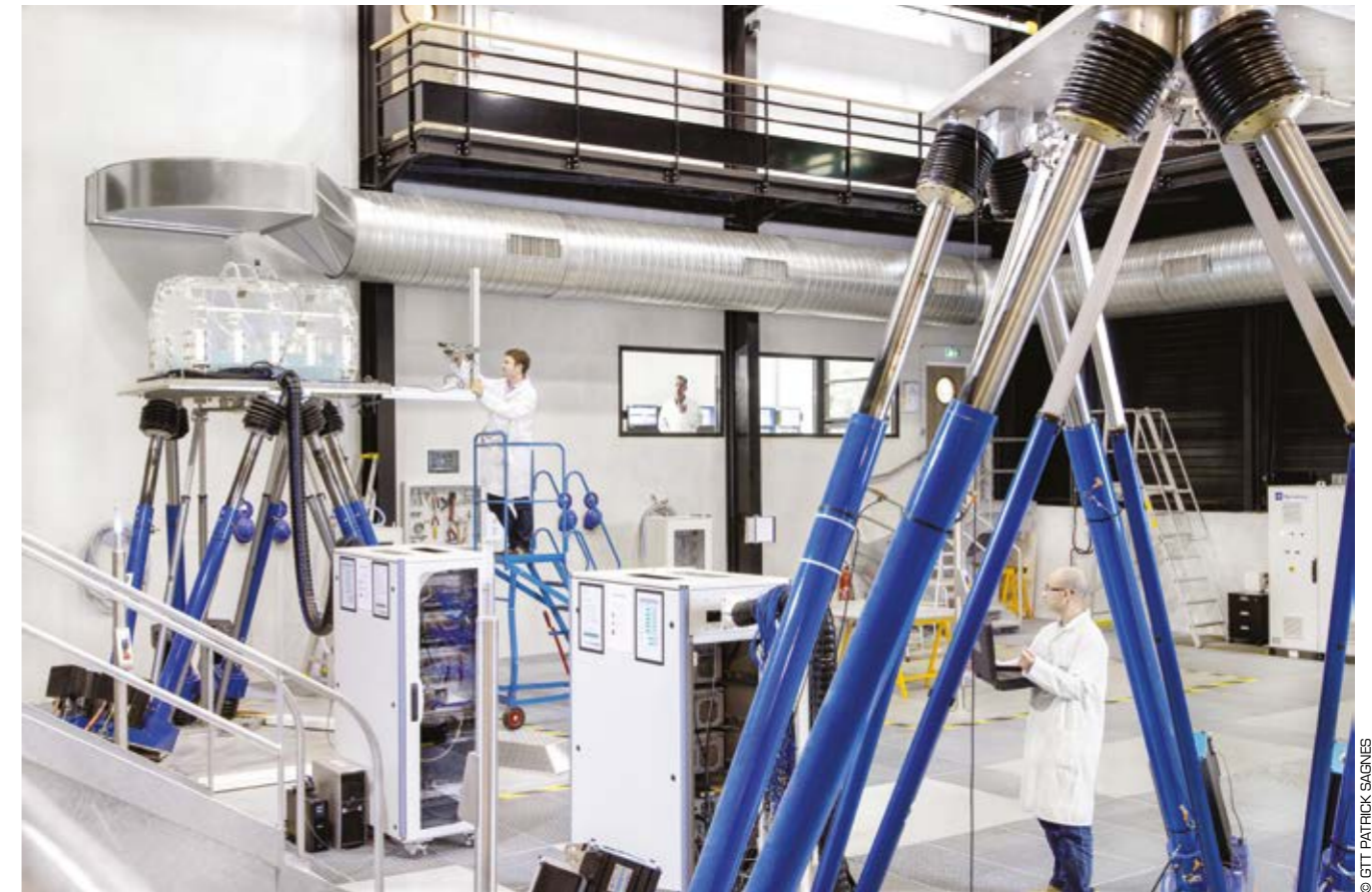
Le laboratoire « Mouvements liquides » de GTT. « Dans le cadre de la maintenance prédictive de la cuve d'un méthanier conçue par GTT, évaluer les conséquences du ballottage du GNL à l'intérieur de la cuve est plus important que d'en prédire le mouvement précis. » Anouar Kiassi
