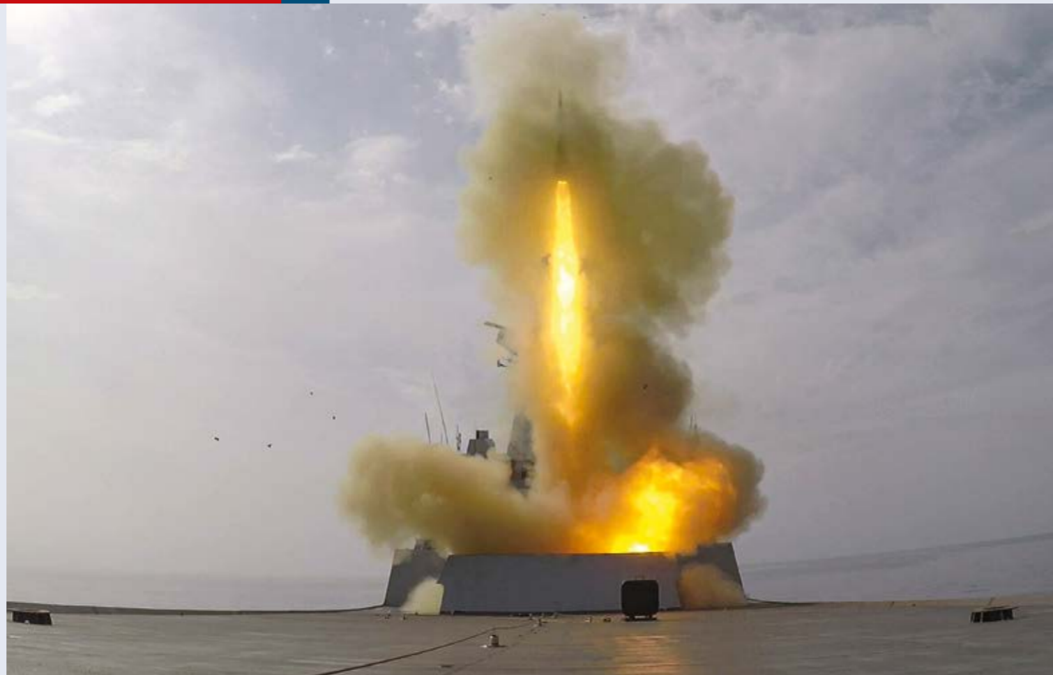
Tir d'un missile Aster depuis une Frégate multi-missions (FREMM). Ce missile fabriqué par MBDA intercepte à 360° avions, drones et missiles de croisière jusqu'à 30 km et 13 000 mètres d'altitude pour l'Aster 15, au-delà de 120 km et 20 000 mètres d'altitude pour l'Aster 30.
