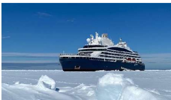
Navire Commandant Charcot, doté de 4520 kWh de batteries
