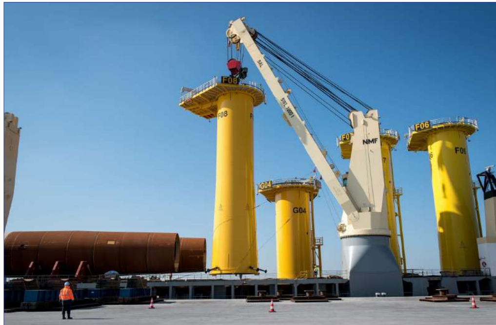
Figure 6 : Les fondations et les pièces de transition des éoliennes en mer du parc de Saint-Nazaire.
