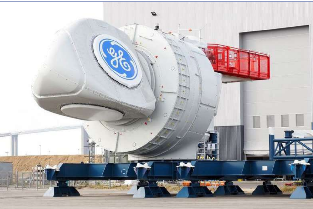
Figure 5 : La nacelle d'une éolienne en mer du parc de Saint-Nazaire.
