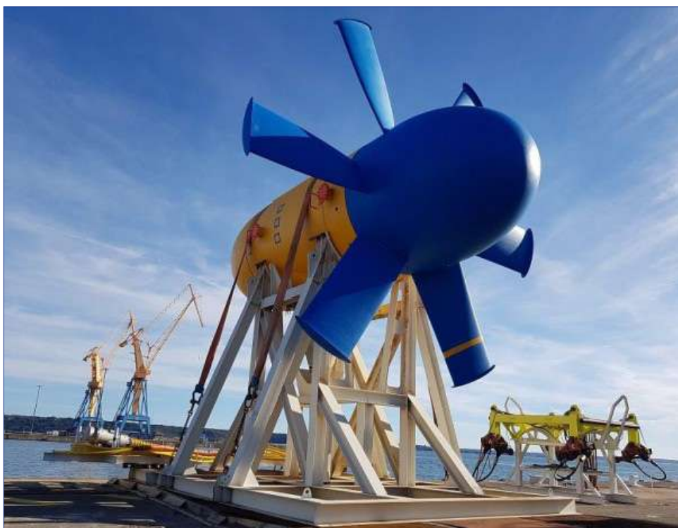
Figure 1 : Hydrolienne utilisée pour le programme PHARE au large de Ouessant.
